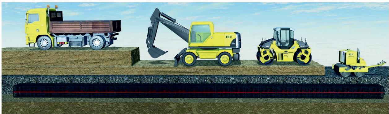
Während der Verfüllung der Baugruben können unterschiedliche Baugeräte verwendet werden. Das direkte Befahren der Rigolenelemente mit Verdichtungsgeräten sowie das Befahren von Verdichtungsgeräten mit eingeschalteten Vibrationsmotoren sind auf Grund der zusätzlichen dynamischen Lasten nicht zulässig.
