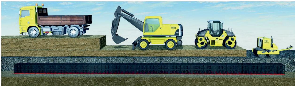
Durante el relleno de fosas de obras pueden emplearse diferentes equipos de construcción. A causa de las cargas dinámicas adicionales, no se permite el tránsito directo por los elementos del canal con equipos de compactación ni el tránsito de equipos de compactación con motores de vibración conectados.
