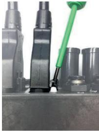
Abbildung 16: Sicherungskralle für 230 V-Stecker lösen
