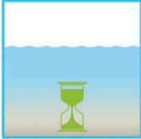
En la segunda fase no se produce ninguna ventilación. Así, el lodo activado y el resto de las materias sedimentables pueden sedimentar por efecto de la gravedad. Se crea una zona de agua limpia en la parte superior y una capa de lodo en el fondo. Los lodos flotantes que puedan producirse se encuentran por encima de la zona de agua limpia.
