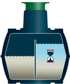
Esta etapa es una fase de reposo en la que no se produce ninguna aireación. Los lodos activados pueden sedimentar por gravedad (fase de sedimentación). Se forma una zona de agua limpia en la zona superior y una capa de lodo en el fondo. Los lodos flotantes que puedan producirse se encuentran por encima de la zona de agua limpia.
