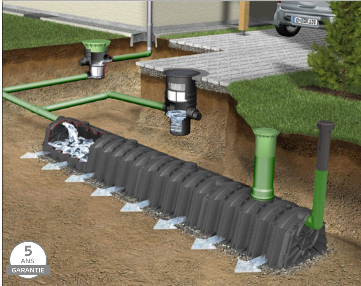
Le tunnel d'infiltration GRAF a été conçu pour une utilisation de préférence là où la superficie d'infiltration est importante (particuliers, zones rurales...). Le système, composé d'un ou plusieurs tunnels et de deux parois, peut être dimensionné à volonté. L'installation des tunnels se fait en une ou plusieurs rangées sur un même niveau.
