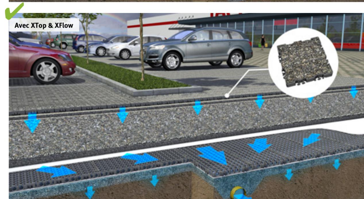
La multiplication des infrastructures (telles que les parkings des supermarchés) aggrave l'imperméabilisation des sols. L'utilisation de surfaces perméables comme les pavés drainants peut permettre d'éviter les inondations en permettant à l'eau de pluie accumulée d'être rapidement infiltrée dans le sol.
