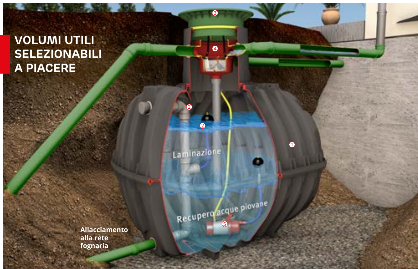
L'immagine mostra la vasca di laminazione Carat Plus con pacchetto filtro di ritenzione 2 Carat (accessori vedi sotto) e il pacchetto pompa Garden Comfort (accessori pagina 66)
