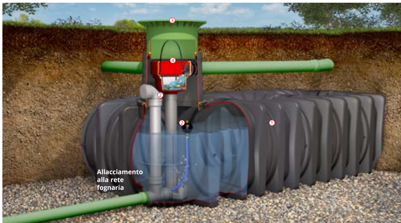
L'immagine mostra la vasca di laminazione Platin XL con pacchetto filtro di ritenzione 2 Platin XL/XXL (accessori vedi sotto)
