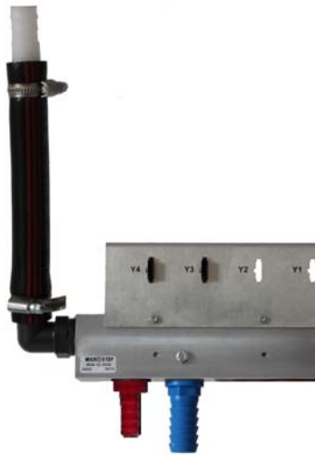
Rampe de vannes (face avant)
