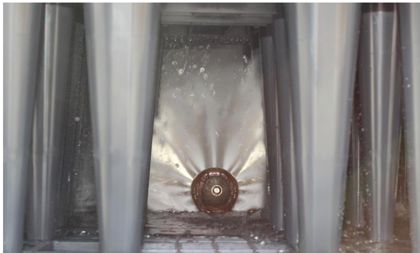
Der EcoBloc Inspect smart ermöglicht eine Hochdruckspülung des gesamten Systems
