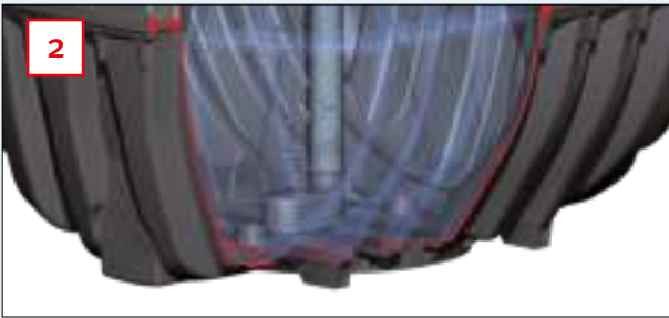
A água filtrada é introduzida através de um dispositivo antiturbulência no fundo do tanque.
