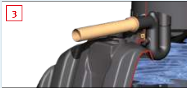
Por ação do sifão de transbordo instalado no tanque, a camada sobrenadante é removida quando o tanque transborda.
