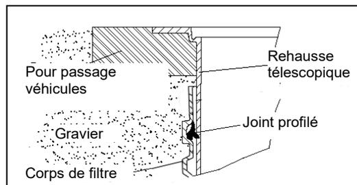
**Attention :** Ne laissez pas sécher la graisse blanche : le positionnement de la rehausse sera plus difficile et le joint profilé risque de se déloger de la rainure et l'étanchéité ne sera plus garantie. Tassez bien le remblai autour de la rehausse manuellement, de sorte qu'aucune pression extérieure ne modifie son positionnement.
