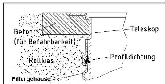
**Achtung:** Trocknet die Schmierseife an lässt sich das Teleskop nur noch sehr schwer bewegen und es besteht die Gefahr, dass die Dichtung aus der Dichtnut rutscht. Vor dem Verfüllen muss die Dichtung auf ihren korrekten Sitz überprüft werden. Das Teleskop muss ausreichend unterfüllt werden, so dass sich Kräfte auf keinen Fall auf das Gehäuse übertragen können.
