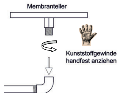
Montage des Tellerbelüfters
