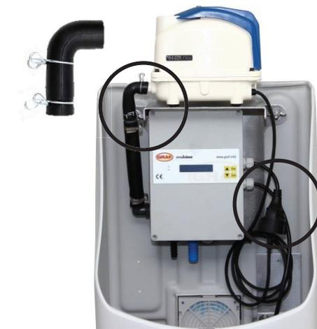
Colocar el compresor sobre el soporte de la parte superior del cuadro de control. Utilizar el codo de goma para la conexión de aire. Conectar el enchufe del compresor en el conector hembra del cuadro de control.
