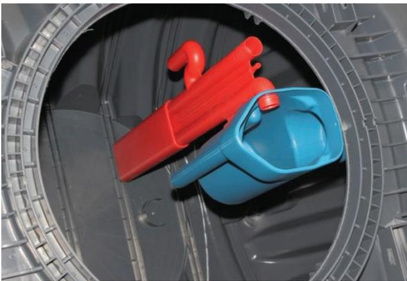
Der Auslaufstutzen der Probeentnahme wird in die Muffe des Auslaufrohres gesteckt (Gleitmittel verwenden!). Die Muffen-Verbindung ist mit einer Spax-Schraube zu sichern.
