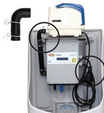
Il compressore viene posizionato sopra la centralina. Per il collegamento dell'aria utilizzare il gomito in gomma. Per l'alimentazione elettrica, collegare la spina del compressore alla presa della centralina.
