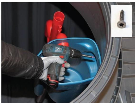
Fissare il contenitore per il campionamento alla torretta del serbatoio utilizzando una vite Spax.
