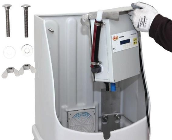
Die Steuerung wird mit den Schrauben und Flügelmuttern, die dem Schaltschrank beiliegen, befestigt.
