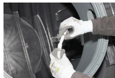
Collegare il tubo di aerazione (13mm) al sifone per l'estrazione dell'acqua chiarificata. Collegare il tubo di aerazione (13mm) al sifone per il recupero dei fanghi.
