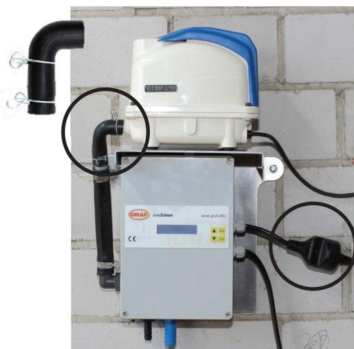
Il compressore viene posizionato sopra la centralina. Per il collegamento dell'aria utilizzare il gomito in gomma. Collegare la spina del compressore alla presa della centralina.
