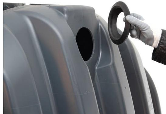
Pulire il foro dalle sbavature. Inserire la guarnizione a labbro DN 110. Per la direzione di inserimento fare riferimento alla figura precedente.
