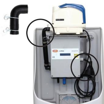
Der Verdichter wird auf die Steuerung gestellt. Zum Luftanschluss ist der Gummi-Winkel zu verwenden. Zum Stromanschluss wird der Stecker des Verdichters in die Buchse der Steuerung gesteckt.
