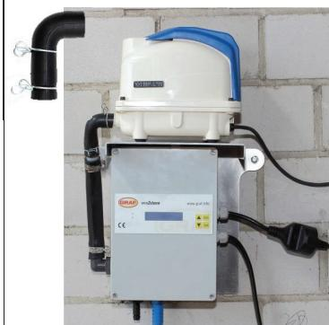
El compresor se monta en el panel de control. Conectar el compresor al panel de control utilizando la manguera con codo de 90 grados y asegurándola con las abrazaderas incluidas. El enchufe del compresor se coloca en el conector del panel de control.
