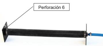
Fijar el cable en el difusor tubular (perforación 6 mm). Conectar la manguera de aire (19 mm) en el lado opuesto. Las instalaciones para más de 7 HAB presentan dos difusores tubulares.
