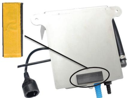
Vor Montage der Steuerung ist auf der Rückseite der Steuerung ein Streifen Moosgummi zu kleben.
