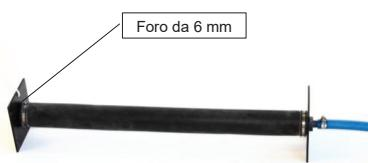
Fissare il laccio all'aeratore tubolare (foro da 6 mm). All'estremità opposta collegare il tubo di aerazione (19 mm). Negli impianti per più di 7 abitanti si utilizzano 2 aeratori tubolari.
