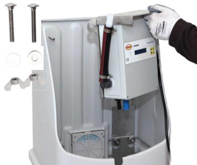
El panel de control debe fijarse al gabinete externo utilizando los tornillos y las tuerca mariposa.
