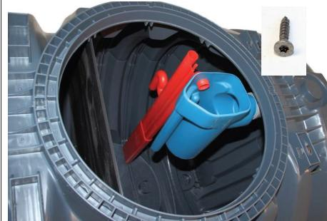
Der Auslaufstutzen der Probeentnahme wird in die Muffe des Auslaufrohrs gesteckt (Gleitmittel verwenden!). Die Muffen-Verbindung ist mit einer Spax-Schraube zu sichern.
