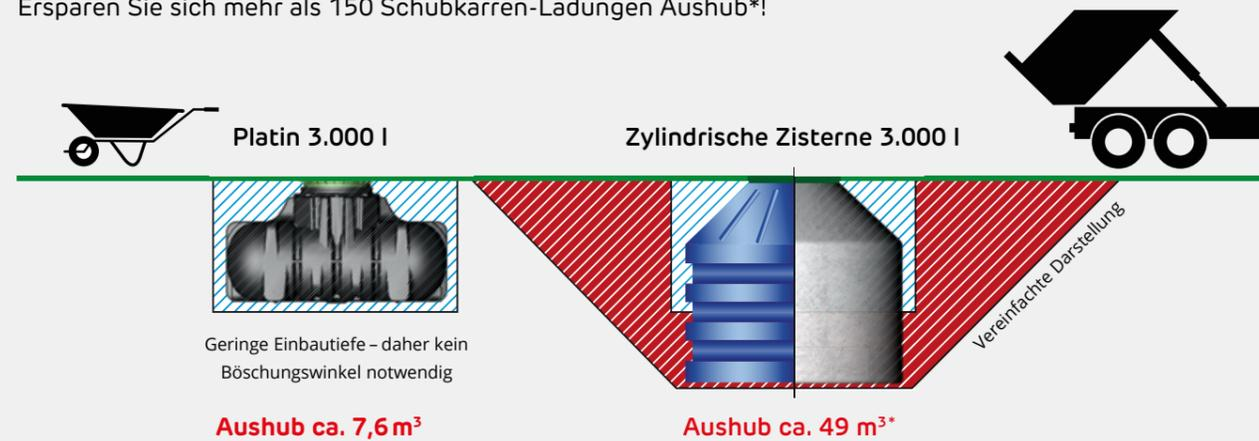
\* Ausgehend von einer stehenden, zylindrischen Zisterne mit Nutzvolumen 3.000 Liter, einer Höhe von 1,90 m und einem Durchmesser von 2,20 m. Berechnung des Aushubs unter Berücksichtigung einer Grubensohle von 10 cm, einem seitlichen Arbeitsraum von 50 cm sowie einer Böschung mit 45° Neigung gemäß DIN 4124.
