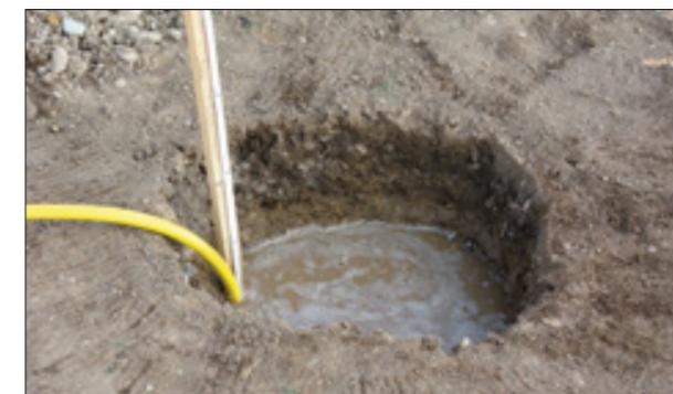
3. Wasserstand nach 30 Minuten kontrollieren. Ist er weniger als 20 mm abgesunken, nach 120 Minuten erneut kontrollieren. Versuch ein zweites Mal durchführen. Bei Abweichungen zum ersten Versuch ist ein dritter Durchlauf notwendig.
