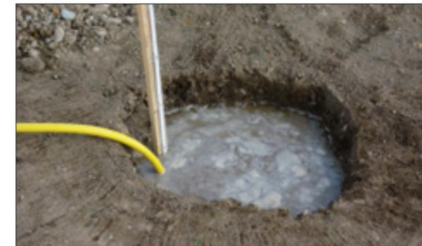
2. Die Grube zu ca. 200 mm mit Wasser füllen, Uhrzeit und Wasserstand notieren.
