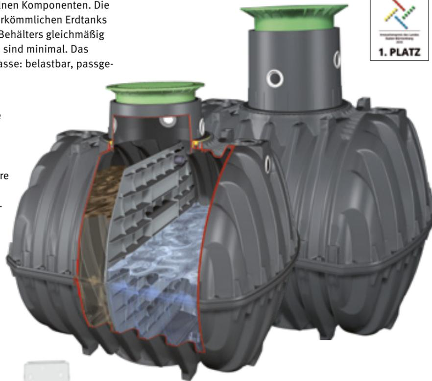
Die Trennwand des Carat Klärbehälters ist genauso einzigartig und stabil wie der Tank selbst. Gefertigt im selben Herstellungsverfahren wie der Tank, wird sie von einem Fertigungsroboter passgenau in den Tank eingeschweißt. Die aufwändige Fertigung gewährleistet eine dauerhaft dichte Trennung zwischen den Kammern.
