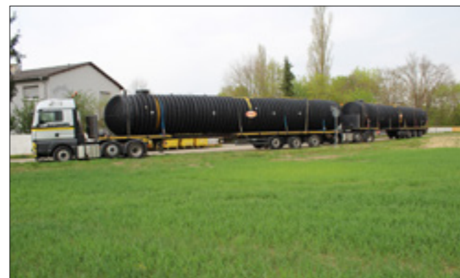
Die beiden Löschwasserbehälter mussten aufgrund der Abmessungen und des geringen Gewichtes nicht als Sondertransport transportiert werden.
