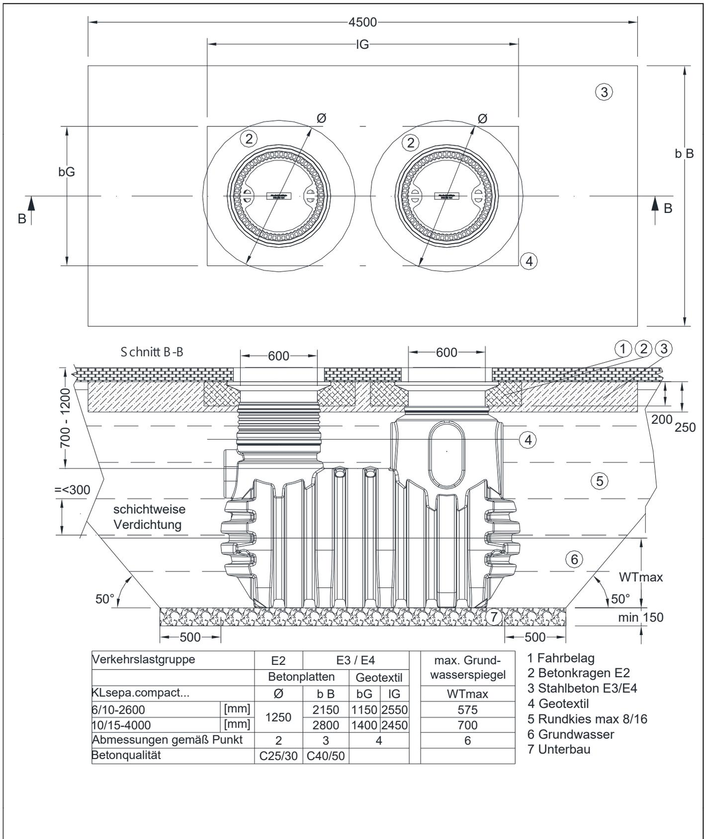
Anlagen zur Begrenzung von Kohlenwasserstoffen in mineralöhlhaltigen Abwässern mit Anteilen an Biodiesel, Bioheizöl und Ethanol - System B -
