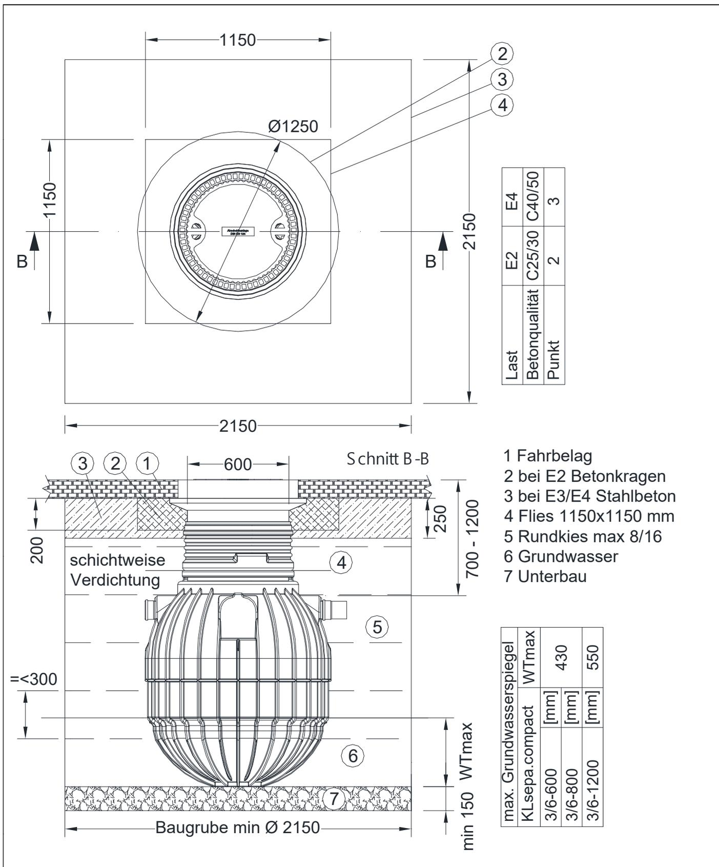
Anlagen zur Begrenzung von Kohlenwasserstoffen in mineralölhaltigen Abwässern mit Anteilen an Biodiesel, Bioheizöl und Ethanol - System B -
