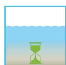
Druga faza procesu oczyszczania odbywa się bez napowietrzania. Osad czynny i pozostałe substancje nierozpuszczalne mogą opaść na dno w wyniku działania siły grawitacji. W górnej części gromadzi się oczyszczony ściek, a na dno opada osad. Występujący ewentualnie osad pływający zbiera się na powierzchni oczyszczonego ścieku.
