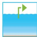
W tej fazie ścieki oczyszczone biologicznie są zasysane z reaktora SBR. Proces pompowania odbywa się za pomocą sprężonego powietrza na zasadzie pompy mamutowej (powietrzny podnośnik cieczy). Jest ona tak skonstruowana, że osad pływający zbierający się ewentualnie na warstwie ścieku oczyszczonego nie jest odpompowywany. Minimalny poziom wody w oczyszczalni utrzymywany jest bez dodatkowych elementów wyposażenia.
