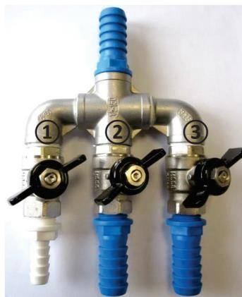
Ilustración 1: distribuidor de aire con válvulas, 1 recirculación del lodo, 2 y 3 aireador.
