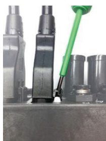
Imagen 16: Aflojar la garra del fusible para los enchufes de 230 V
